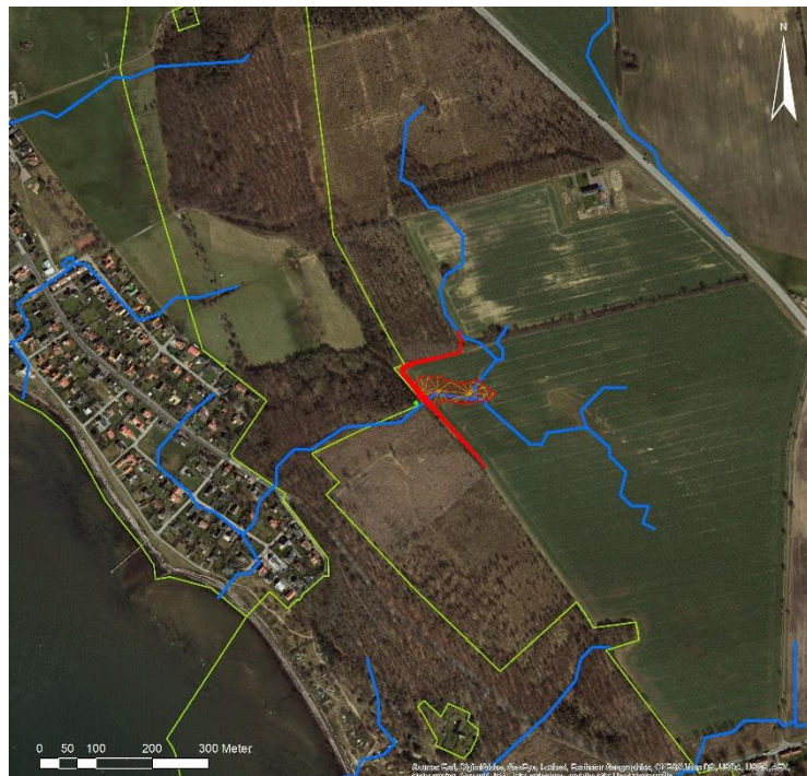
Figur 3. Flygbild över placering av skyddsvallen (röd linje) samt avrinning ner i ravinen (blå linje). Den röda skrafferade ytan visar planerad utfyllnad (se nedan).
