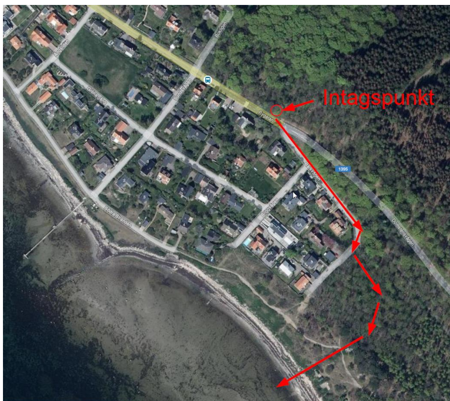
Figur 1. Översiktlig bild över hur vatten från ravinen leds till Öresund.
