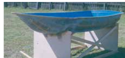
Skrovet är färdigt och har tagits ur sin form.
