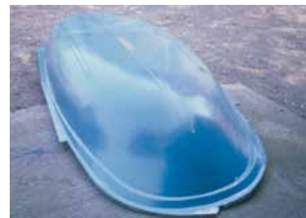
Kanterna runt formen skall jämnas till och putsas innan gummirelingen kan sättas på.
