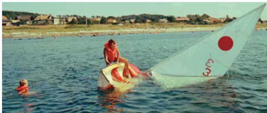
Ingvar Frost testar jollens sjöegenskaper genom att försöka välta den, medan sonen tittar på. Riggen var lite för hög för båtens storlek, eftersom man köpt en standardrigg från Fabola.
