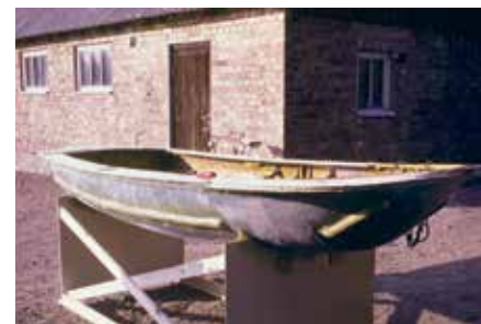
Här är "pluggens" insida färdiggjuten.
